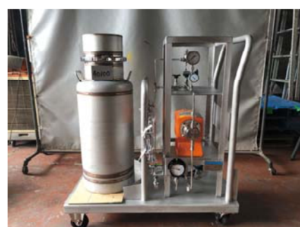
【非常用ポンプ注入式付臭装置】
